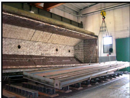
ELEMENT LINII POLSKIEJ OPUSZCZA PIEC PO OBRÓBCE CIEPLNEJ
