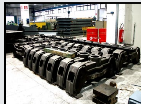
MOSTY LINII KALIBRUJĄCEJ PRZED DALSZĄ OBRÓBKĄ
