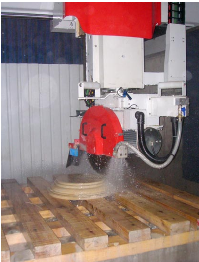
Wykonywanie okrągłej i profilowanej nakrywy z piaskowca
