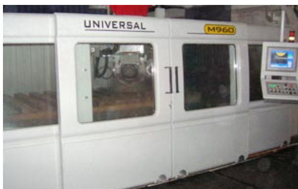
Maszyna w trakcie pracy z zamkniętymi osłonami bezpieczeństwa
