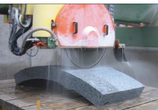
Fot. 6. M940CN wykonująca wygładzanie wyprofilowanej powierzchni łupiny.
