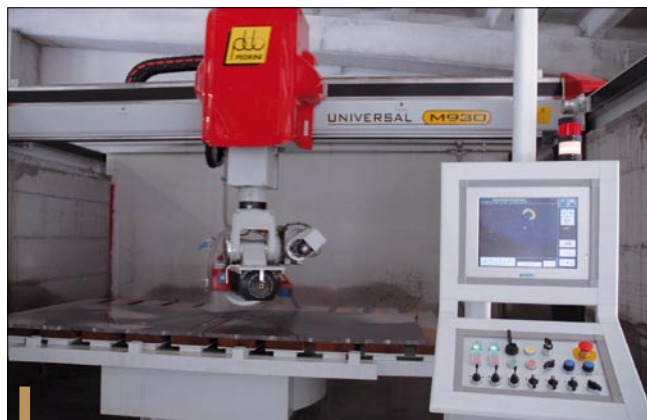
Fot. 3: M930 TG : na pierwszym ekranie panel sterujący w funkcji symulacji obróbki
