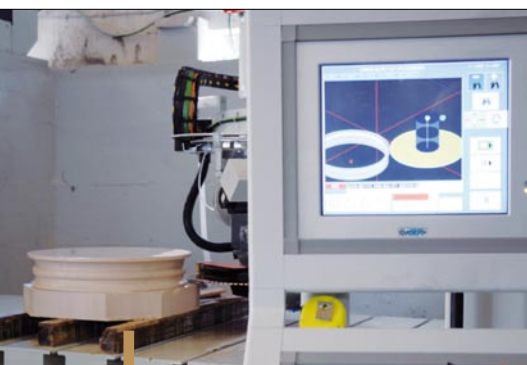
Fot. 4. Panel sterujący – wspólny dla wszystkich 3 typów maszyn.
