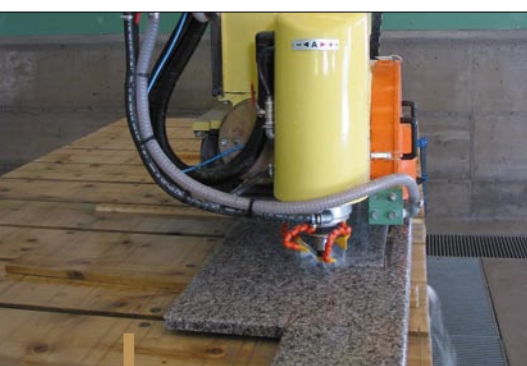
Maszyny M940CN i M960TG wyposażono w elektrowrzeciono
